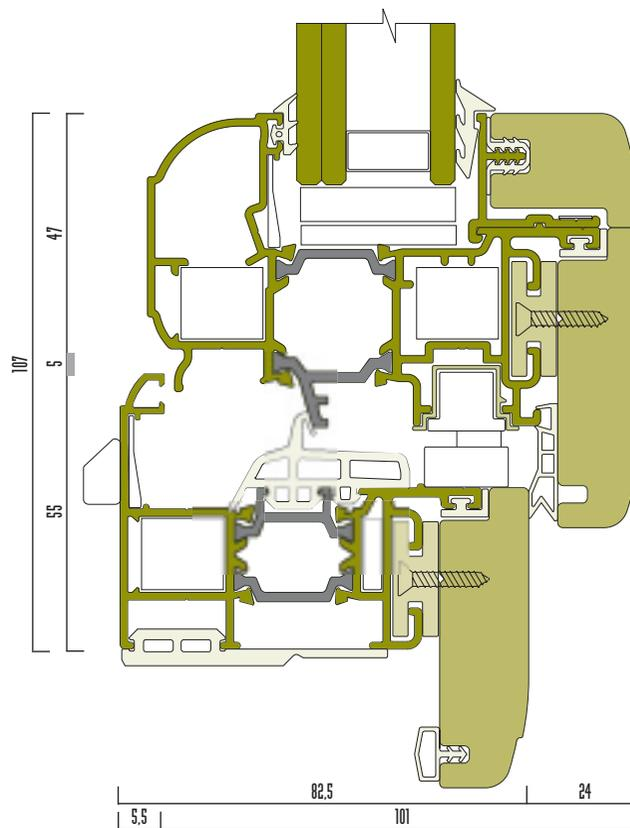
sezione telaio fisso 83 mm
