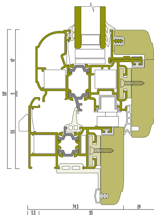
sezione telaio fisso 75 mm
